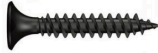
6 x 1 P. Aguda gris fosfato Ideal para fijar placa de yeso de 1/2 a perfiles cal. 26 a 24
