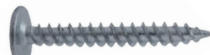
8 x 1 1/4 P. Aguda Avellan Zinc Ideal para fijar placa de Fibrocemento de 14 mm a 20 mm a perfiles cal.20 a 24
