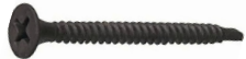
6 x 1 - 5/8 P. Broca gris fosfato Ideal para fijar placa de yeso de 5/8 a perfiles cal. 20 a 24
