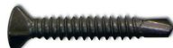
8 x 1 1/4 P. Broca Avellan Porcelanizado Ideal para fijar placa de Fibrocemento de 10 mm a perfiles cal. 24
